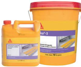
• Rendimiento: Entre 13,5 y 22 kg o entre 10,8 y 17,6 l aprox. para 1 m<sup>3</sup> de hormigón • Dosificación: Sika 3 se puede emplear puro o disuelto hasta en 15 partes de agua, dependiendo del uso y las necesidades de la obra. • Almacenamiento: Se debe mantener en un sitio fresco y bajo techo.
