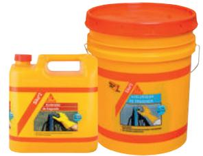
• Rendimiento: 40 cm<sup>3</sup> por cada 100 gr de cemento, obteniéndose 70 cm<sup>3</sup> de pasta • Dosificación: Deben mezclarse en forma rápida dos partes de cemento fresco con una parte de Sika 2 en volumen. • Almacenamiento: Se debe mantener en un sitio fresco y bajo techo.
