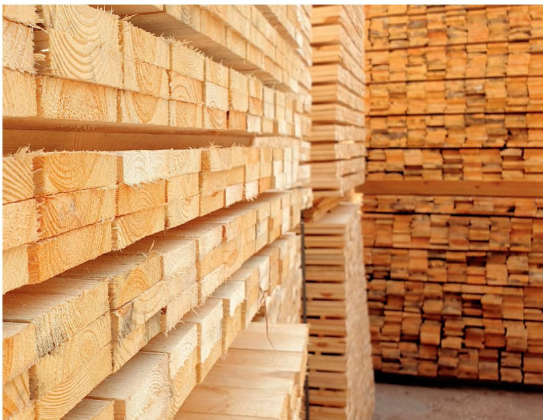
Este proceso consiste en colocar la madera apilada en una bodega o túnel cerrado y aislado térmicamente. Este método suministra calor (temperatura) y controla la humedad relativa del aire en la cámara con el uso de ventiladores y rociadores de agua, esto permite que el aire dentro de la cámara este constantemente seco y arrastre la humedad superficial de la madera.
