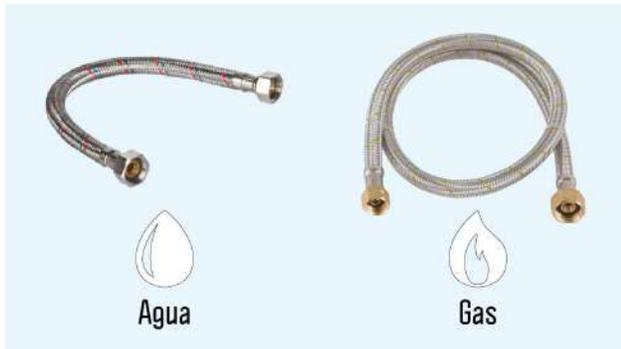
Además de la grifería, es importante revisar los flexibles que van por debajo del lavaplatos y conectan la salida del agua con nuestra llave. Esta manguera se puede tapar debido a los minerales y sarro que viene en el agua.
